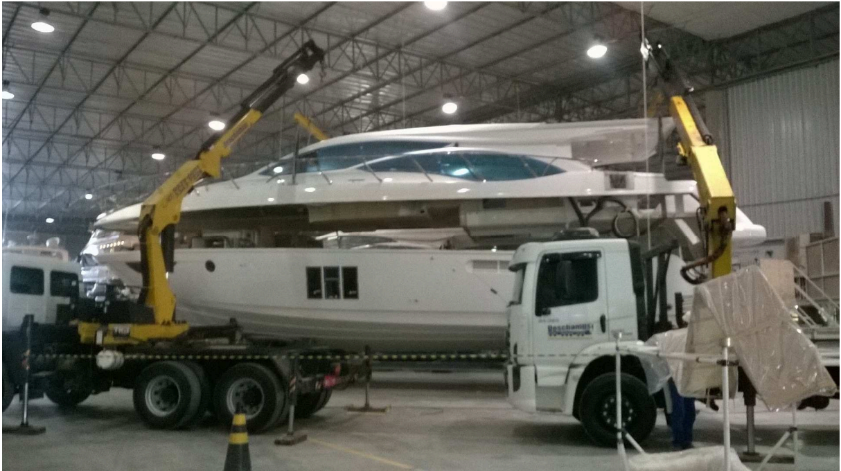
Figura 5. Fechamento e união do casco com o convés de uma embarcação de recreio.
