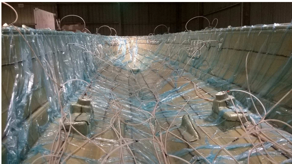
Figura 2. Processo de fabricação de um casco por método de infusão.
