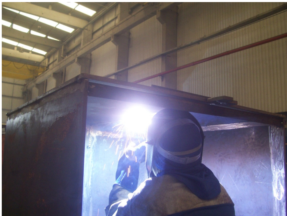
Figura 42 Soldagem da junta de topo sobre-cabeça
