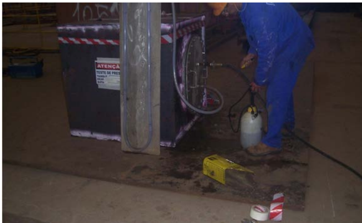
Figura 67 Pressurização do tanque durante o teste
