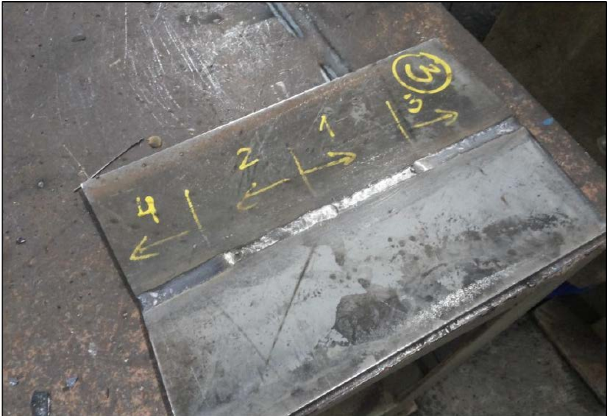
Figura 7 Sequência de Soldagem com distorções minimizadas
