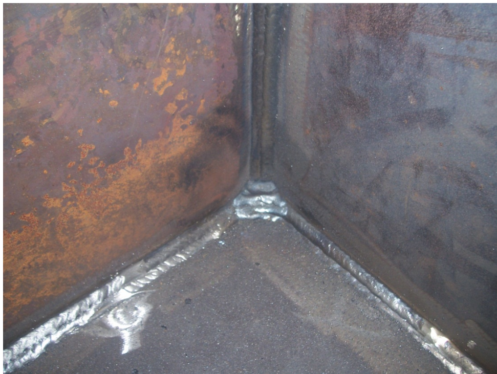
Figura 51 Sequência de solda encerrada no pé de galinha
