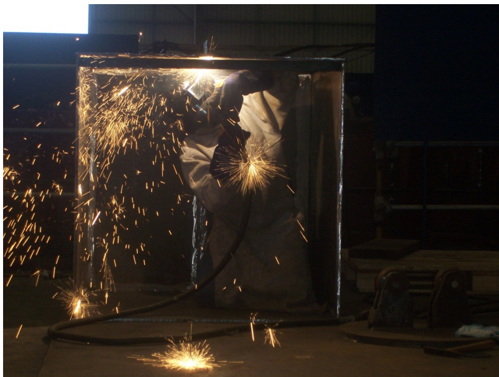
Figura 37 Goivagem da junta de topo na posição sobre-cabeça
