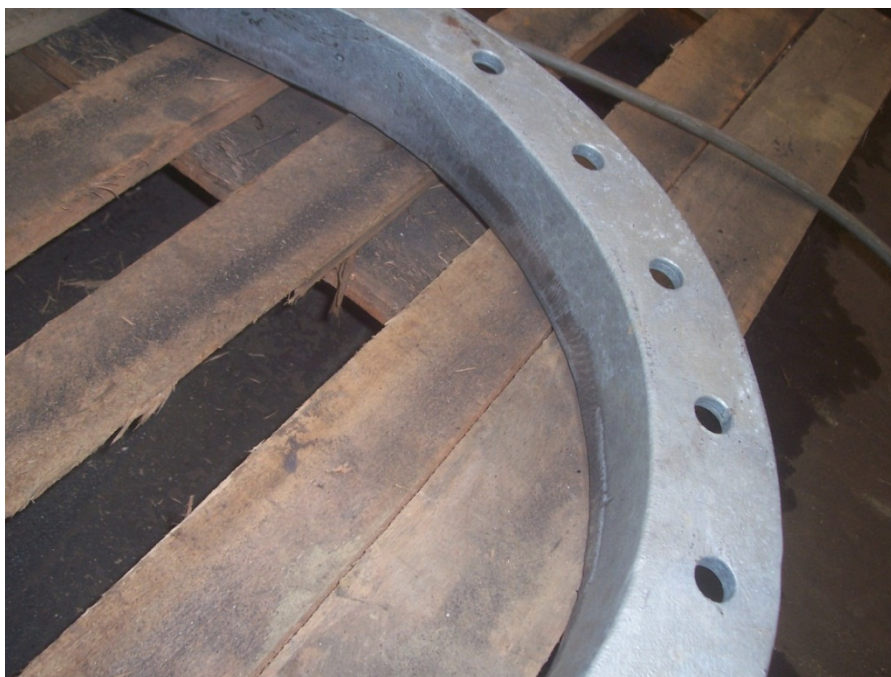
Figura 55 Suporte Galvanizado da porta de visita lixado, preparado para montagem
