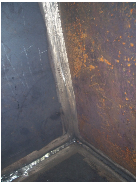
Figura 48 Continuidade do passe de raiz
