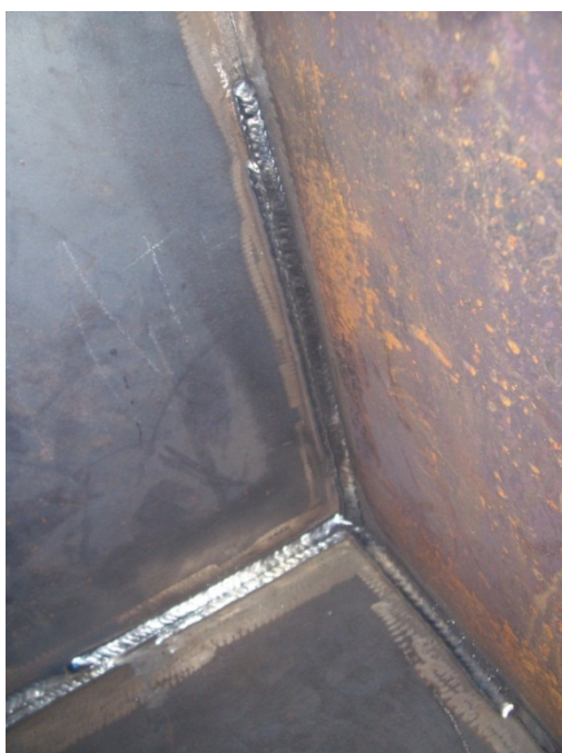
Figura 50 Continuidade do segundo passe de solda
