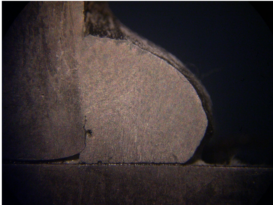
Figura 5 Falta de fusão em uma junta em ângulo
