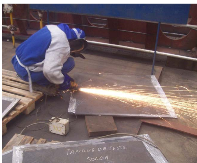
Figura 34 Preparação de junta anterior à montagem
