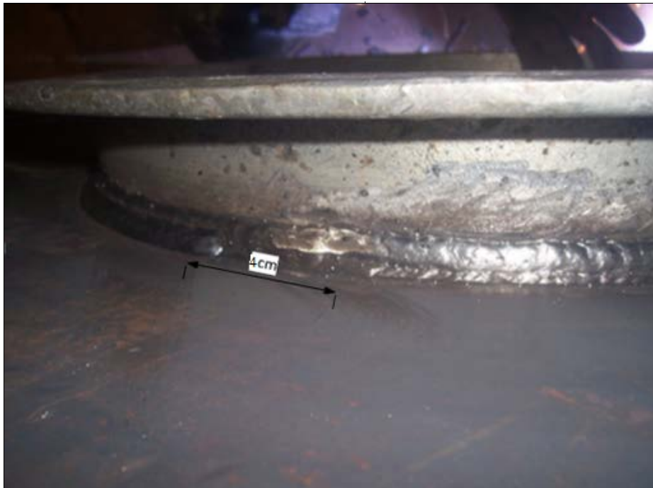
Figura 63 Não-sobreposição dos locais de abertura e fechamento de arco entre passes
