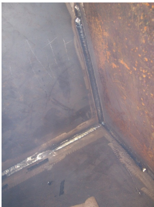
Figura 49 Continuidade do segundo passe conforme sugerido na sequência de soldagem
