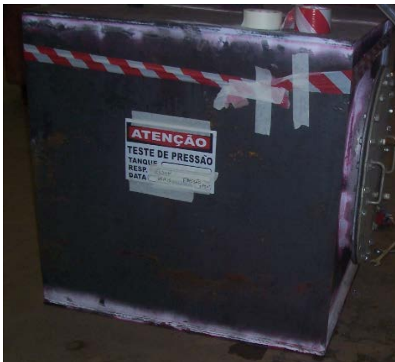
Figura 66 Teste de pressão no tanque protótipo
