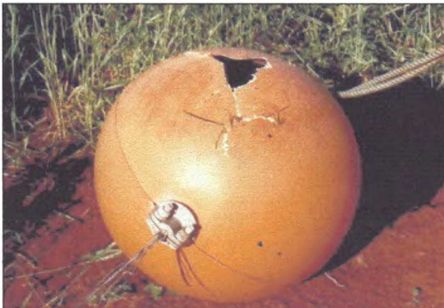
**FIGURA 1** - Detalhe do local do rompimento do cabo pára-raios.
