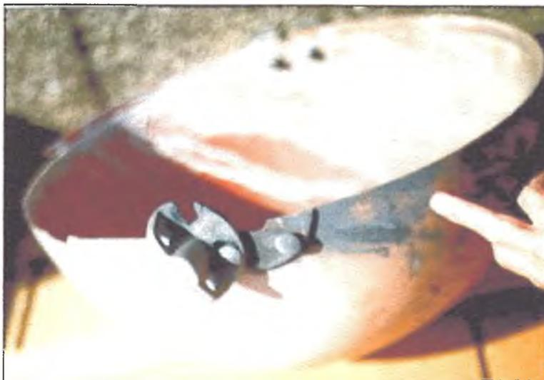
**FIGURA 38** - Detalhe do flange de fixação da esfera danificado.
