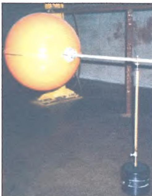
**FIGURA 29** - Excitador eletrodinâmico e célula de carga.
