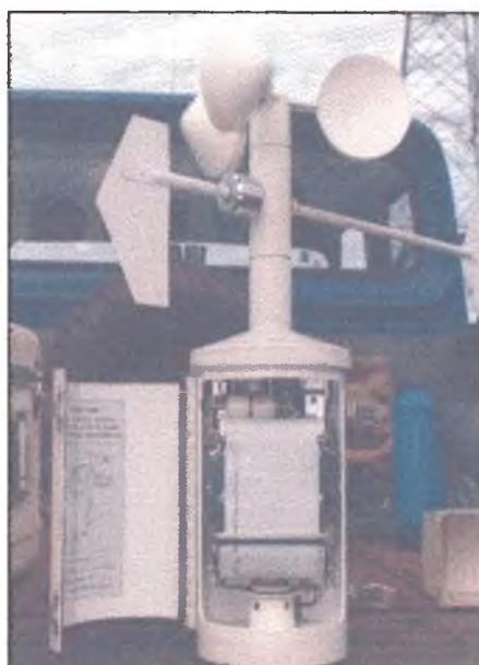
**FIGURA 18** - Anemógrafo Meteorology Research Inc.
