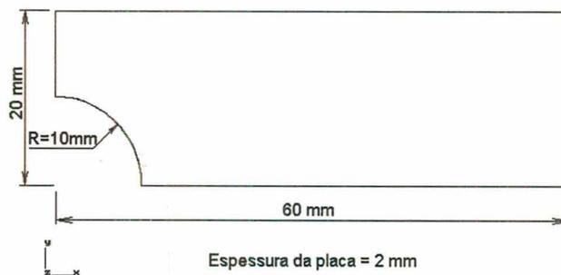
Figura 23: Geometria da placa retangular furada.
