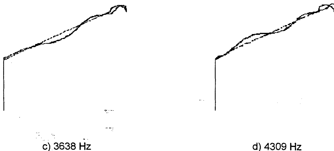
figura 4.5 : Modos de Vibração Calculados Para Cone, Bobina e Borda, Alto-falante Proposto por Shindo [23] (continuação)
