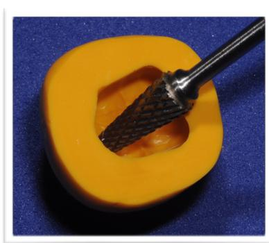
Figura 38 - Alívio da peça de silicone com uma fresa.
