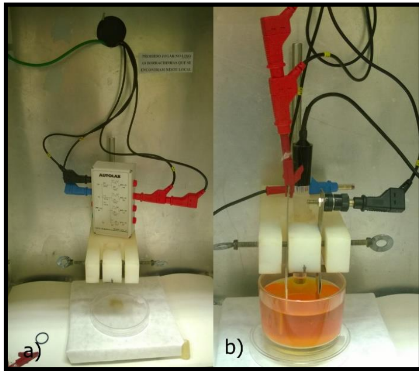
Figura 14: a) Aparato para eletrossíntese, b) Sistema de eletrossíntese montado. Fonte: Autor
