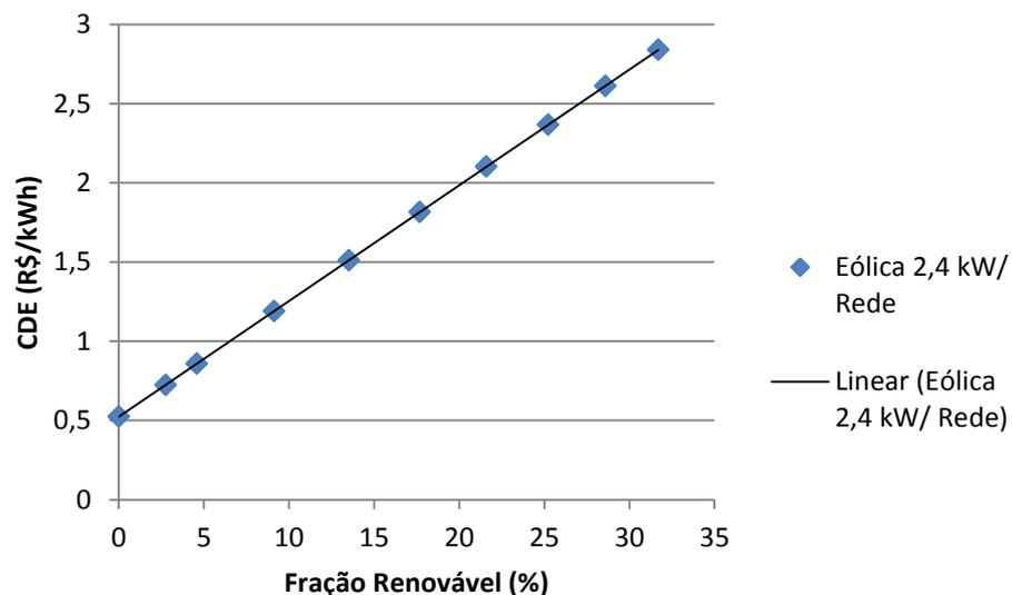
Figura 7 - Relação entre o CDE e a fração renovável de um sistema com geradores eólicos de 2,4 kW conectado à rede.
