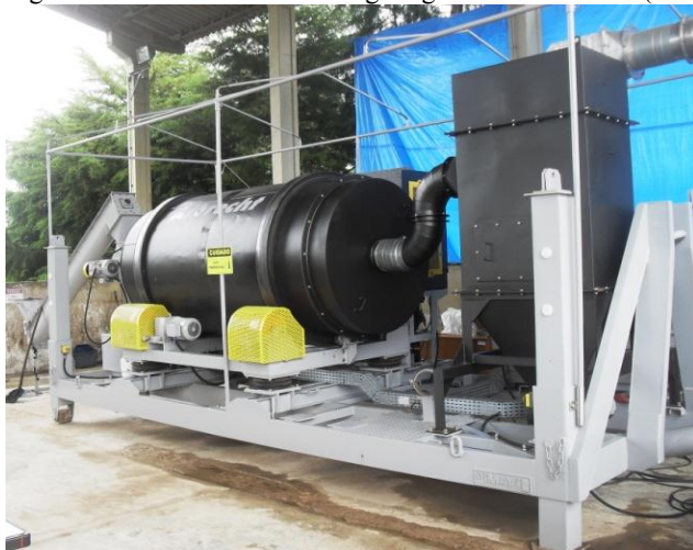
Figura 9 - Secador de lodo de esgoto granulador rotativo (Bruthus).
