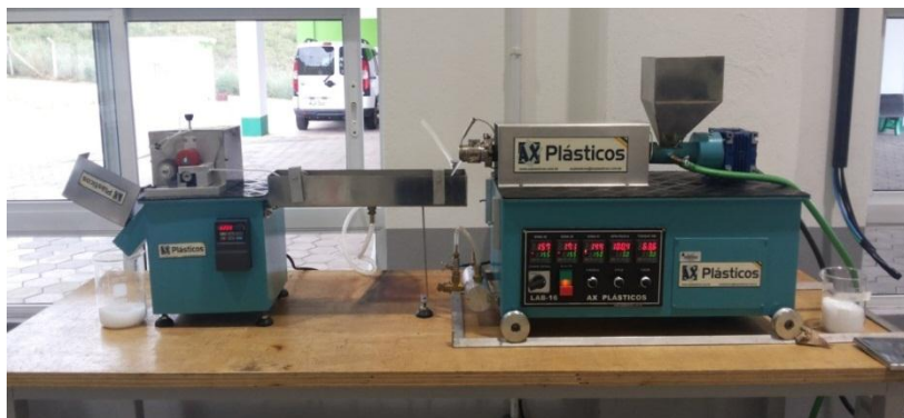
Figura 19 – Extrusora de bancada, tipo monorosca, durante processamento do masterbatch .
