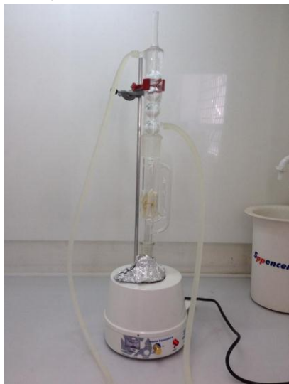
Figura 21 – Sistema de extração do polifenilfosfonato aditivado em filmes de PEBD.
