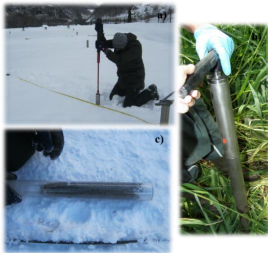
Figura 34 – Coleta das amostras para análises moleculares Amostragem, b) com destaque para o trado e, c) tubo de plexiglas .
