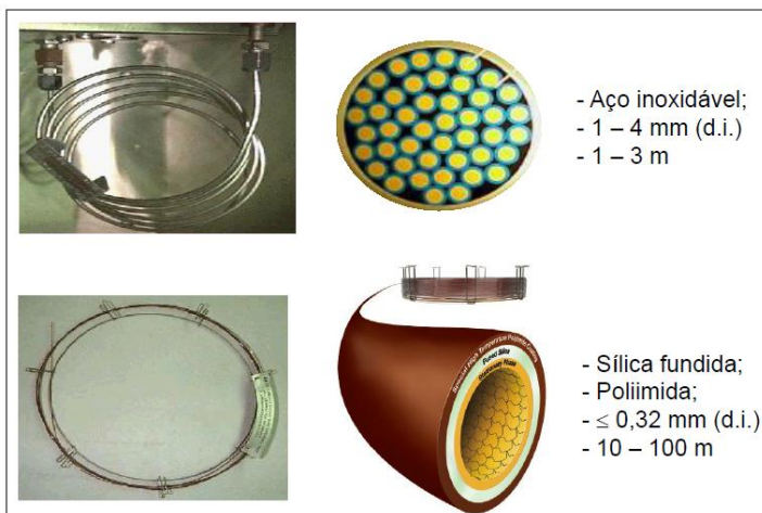
Figura 5. Exemplos de colunas capilares: aço inoxidável e sílica fundida.
