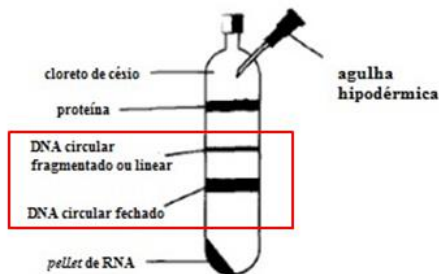
Figura 18 - Tubo da ultracentrífuga após a purificação do DNA plasmidial com cloroeto de céσιο. A agulha hipodérmica na parte superior é importante para retirada do ar, possibilitando assim a coleta das bandas na parte inferior. Fonte:
