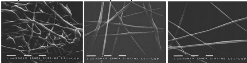
Figura 6: Influência da distância da agulha ao coletor em nanofibras de poliacrilonitrila (PAN): da esquerda para direita, 2 cm, 8 cm e 12 cm
