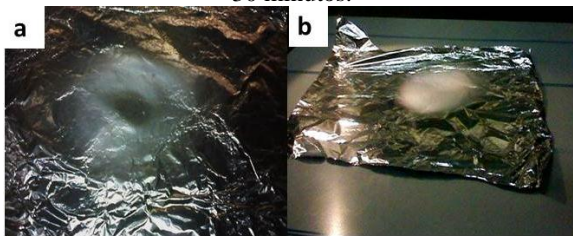
Figura 17: Fibras coletadas no alumínio na voltagem aplicada no injetor de 5,0 kV (a) e 7,0 kV (b). A taxa de vazão foi de 0,5 mL/h, fibras coletadas durante 30 minutos.
