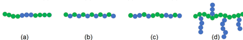
Figura 2. Classificação dos copolímeros de acordo com a disposição de seus monômeros: (a) em bloco, (b) alternado, (c) aleatório e (d) enxertado.
