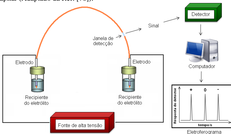
Figura 20. Representação esquemática de um equipamento de eletroforese capilar (Adaptado da Ref. [76]).
