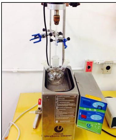
Figura 14 - Sistema experimental utilizado para a produção de nanopartículas de \alpha\text{-Fe}_2\text{O}_3
