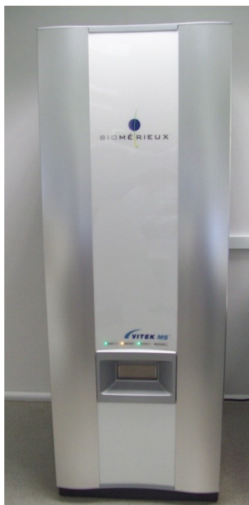
Figura 2 – Equipamento que utiliza a tecnologia MALDI-TOF MS – VITEK MS (bioMérieux).
