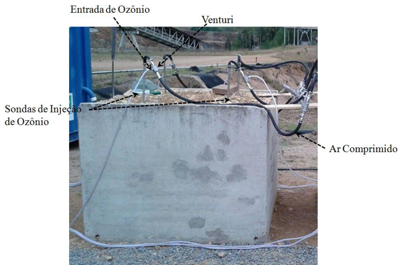
Figura 33: Foto da pilha-piloto de estéril de mineração de urânio, construída a partir do trabalho realizado com o estéril de mineração de carvão.
