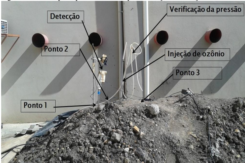
Figura 27: Foto da pilha-piloto construída para avaliação do avanço do ozônio.
