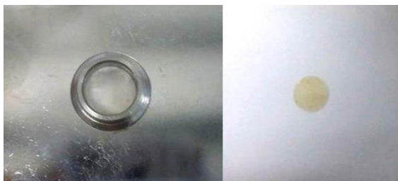
Figura 4. Pastilha de brometo de potássio (KBr) preparada a partir da fração butanólica para análise em espectroscopia de infravermelho.
