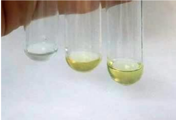
Figura 9. Reação de Liebermann-Burchard para análise qualitativa de esteroides. O tubo-teste (centro) contém o extrato acrescido dos reagentes. Tubo da esquerda contém a solução branco e o da direita o extrato. Créditos: do Autor.
