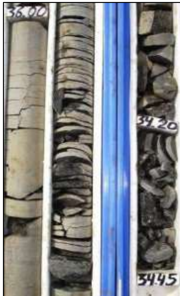
Figura 8 - Fenômeno de core discing em testemunho de sondagem. Fonte: MELO, 2010.
