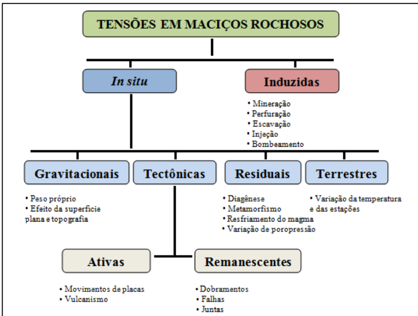
Figura 3 - Tipos de tensões em maciços rochosos (modificado). Fonte: SILVA, 2008.
