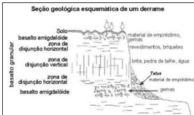
Figura 19 - Seção esquemática de um derrame basáltico. Fonte: CPRM, 2015.
