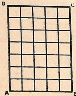
Suponhamos que a base *AB* meça 5m e a altura *AD*, 7m. Sobre a base *AB* marquemos pontos que a dividam em 5 partes iguais e sobre a altura *AD* marquemos pontos que a dividam em 7 partes iguais. Cada parte mede, evidentemente 1m de comprimento. Se por esses pontos traçarmos paralelas à altura e à base, respectivamente, decomporemos o retângulo em 5 quadrados de 1m<sup>2</sup>.
