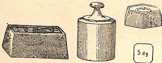
2.<sup>a</sup> série — Para as pesadas médias existem 14 pesos de cobre ou latão, que vão de 20<sup>kg</sup> a 1<sup>g</sup>. Têm a forma de um cilindro, terminando por uma especie de botão.
