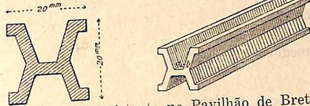
O metro-padrão, existente no Pavilhão de Breteuil é de platino iridiado (\*) que é uma liga inalterável, e tem a forma indicada na figura acima. A peça tem um comprimento total de 102 centímetros e 2 centímetros de altura. O comprimento do metro é indicado por duas ranhuras, uma próxima de cada extremidade.
