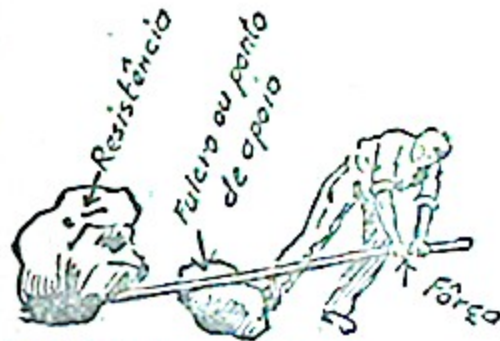
Levantando uma pedra com o auxílio de uma alavanca.
