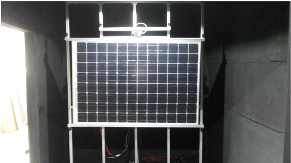
Figura 18 – Estrutura de suporte com a célula de referência e o módulo de amostra. Fonte: do autor.
