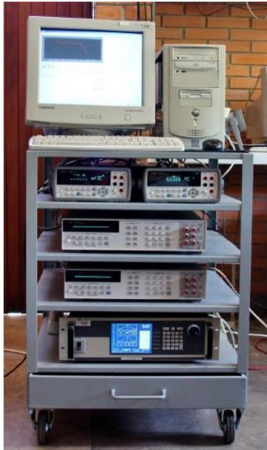
Figura 21 – Equipamentos utilizados para realização da curva I-V de módulos fotovoltaicos. Fonte: GASPARIN, 2011.
