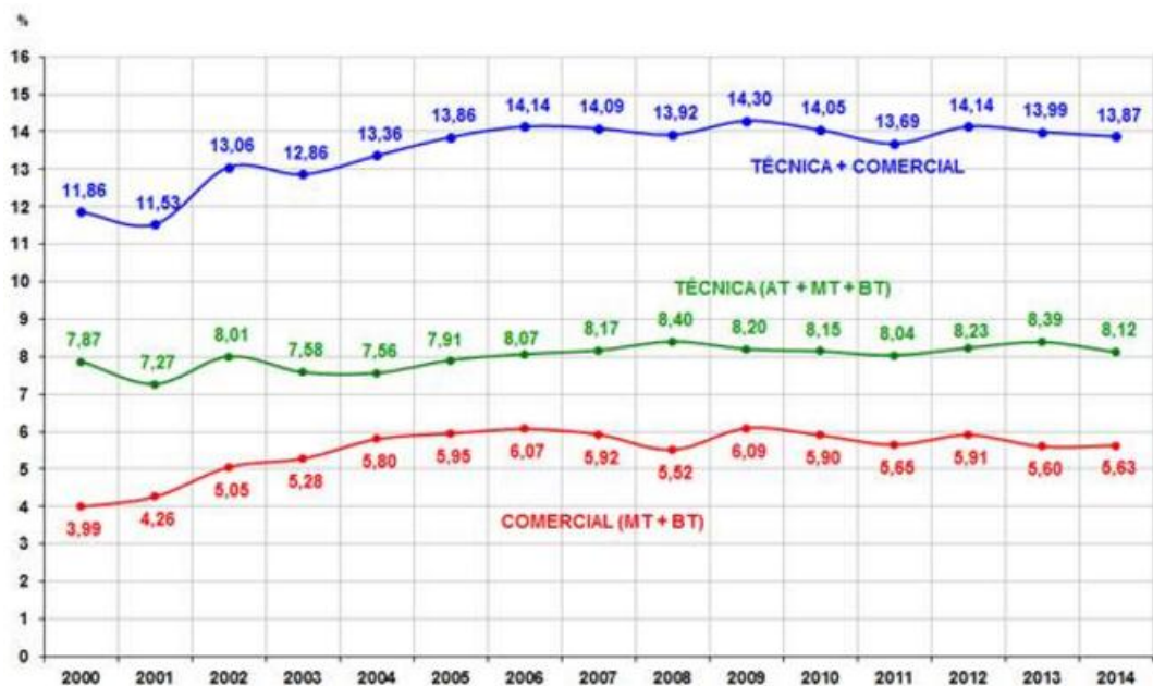
Figura 2 - Percentual de perdas em relação à energia injetada no sistema global de 64 concessionárias no período de 2000 a 2014. Fonte: ABRADEE, 2016.
