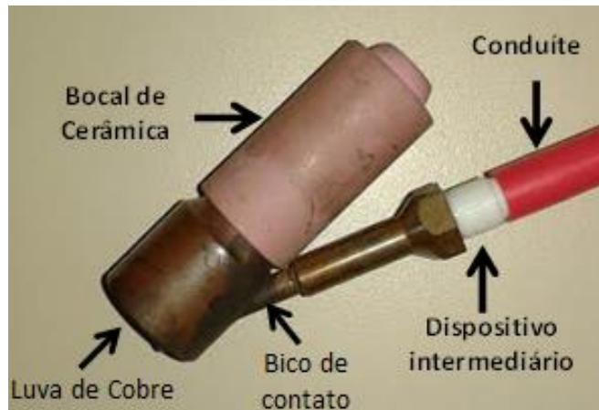
Figura 5 - Dispositivo de Teflon utilizado para evitar aquecimento demasiado do Conduíte
