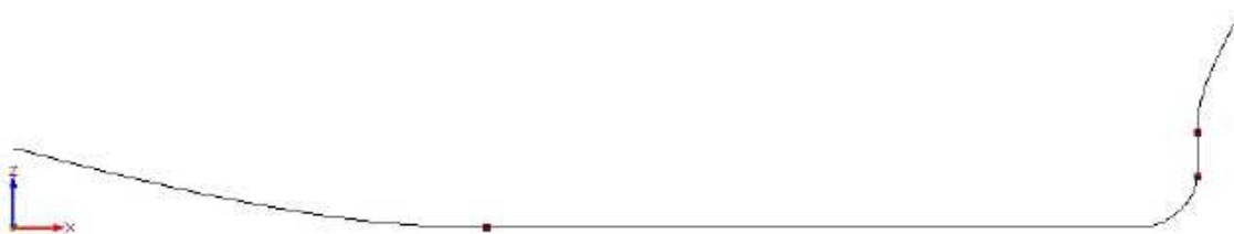
Figura D2 - União da curva da quilha e stem , resultando na curva CPC
