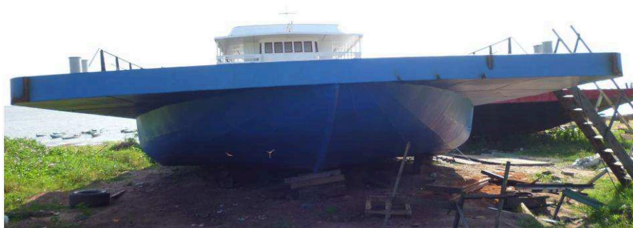
Figura 18 – Convés retangular e formas arredondadas de casco.
