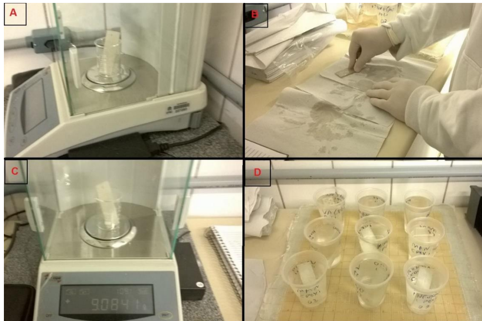
Figura 8 - Etapas do ensaio de absorção de água: (A) pesagem inicial dos CPs, (B) CPs sendo secos para serem pesados, (C) pesagem dos CPs após sua secagem e (D) CPs nos recipientes plásticos onde ficaram submersos durante todo o ensaio
