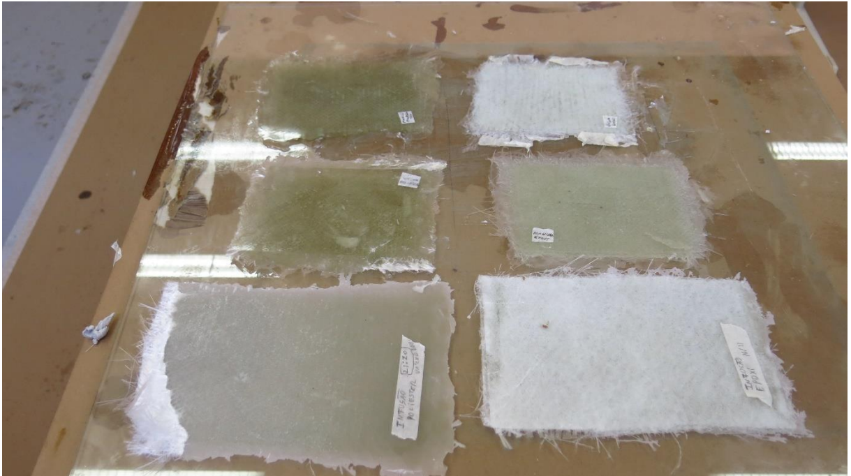
Figura 6 - Placas retangulares laminadas após a desmoldagem
