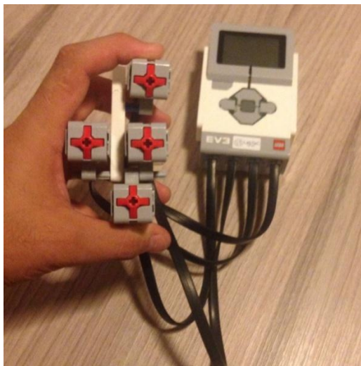
Figura 22 Controle remoto com touch sensores acoplados a um bloco LEGO EV3.
