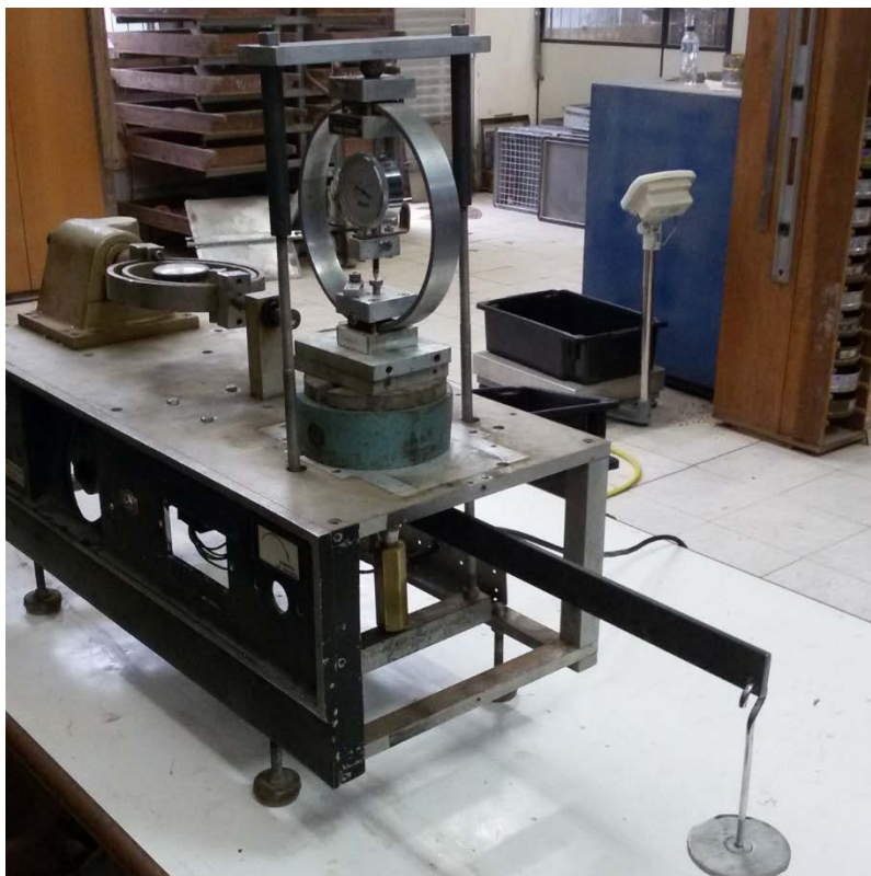
Figura 23 - Calibração do Sistema de Aplicação de Força Confinante Através de Alavanca
