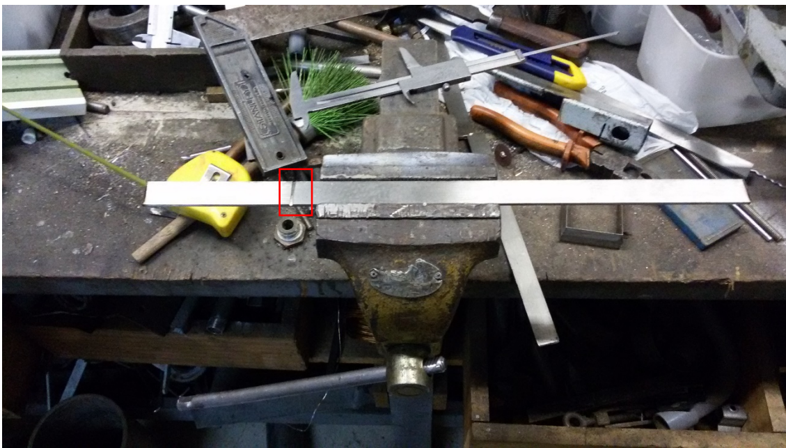
Figura 25 - Fabricação de Moldes para Cisalhamento Direto, detalhe (vermelho) do desgaste para facilitar a dobra
