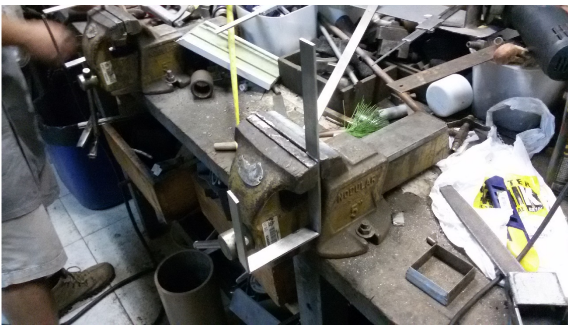
Figura 26 - Fabricação de Moldes para Cisalhamento Direto, processo de dobragem
