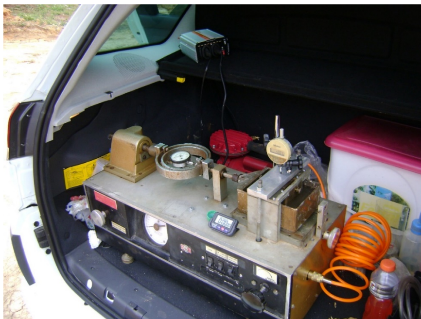
Figura 31 - Cisalhamento Direto em Campo, Equipamento com Sistema Pneumático de aplicação de forças confinantes
