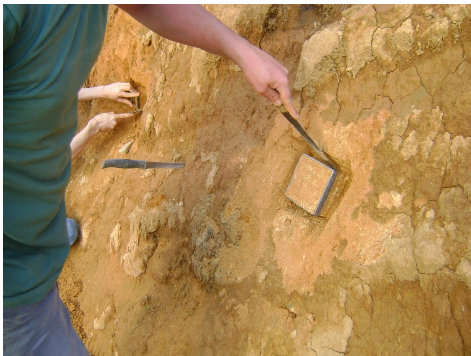
Figura 24 - Moldagem Indeformada de Corpos de Prova em Encosta
