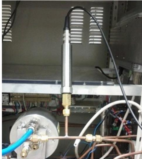
Figura 5.2: Novo transmissor de pressão instalado no aparato atual
