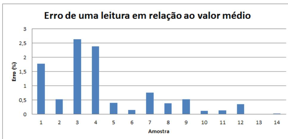
Figura 7.7: Erro da vazão instantânea no instante de 60 s em relação à vazão média
