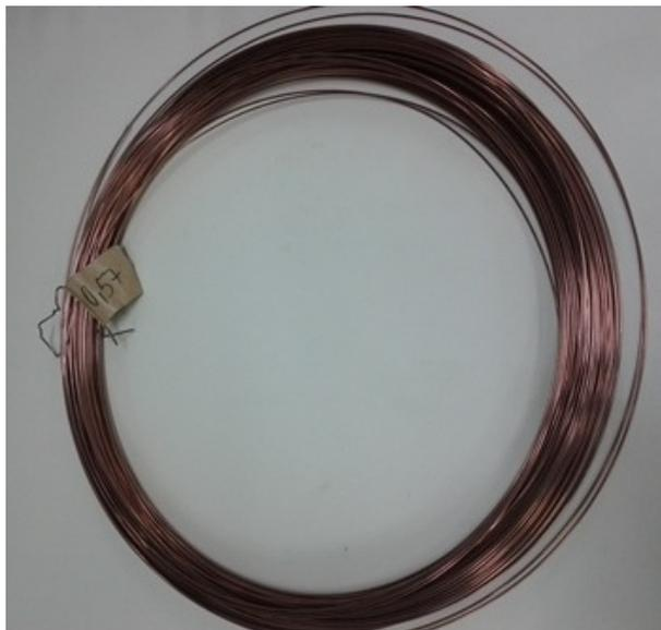
Figura 1.2: Rolo de tubo capilar típico
