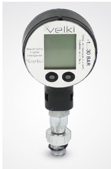
Figura 5.5: Manômetro digital selecionado para medir pressão no novo aparato experimental
