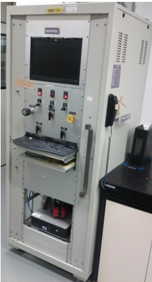
Figura 3.4: Aparato para medição de vazão em tubos capilares atual
