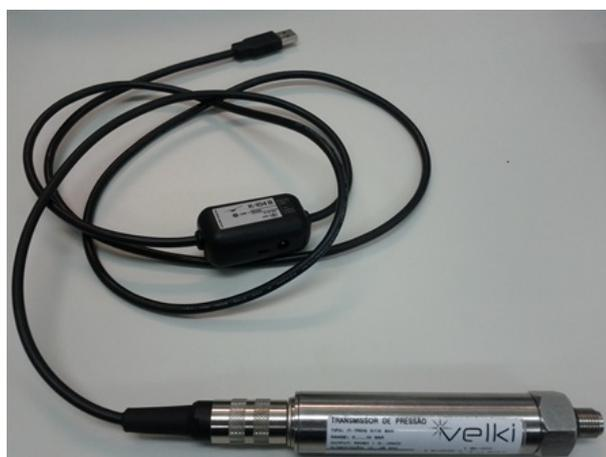
Figura 6.1: Conversor USB ↔ RS-485 K-104 conectado ao transmissor de pressão
