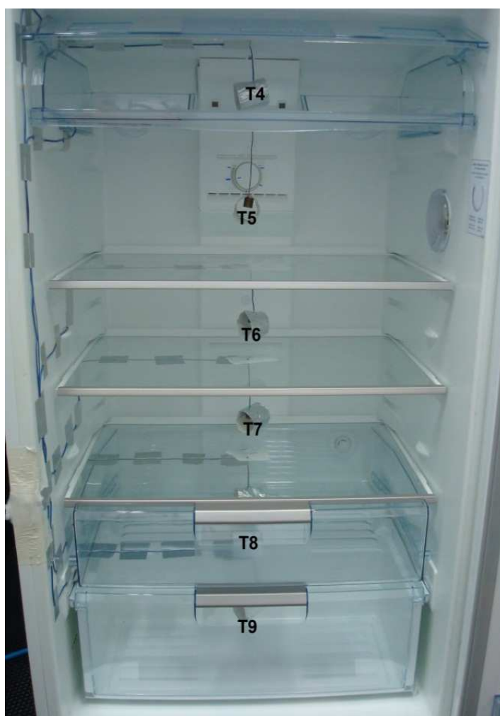
Figura 4.4 Termopares no refrigerador.
