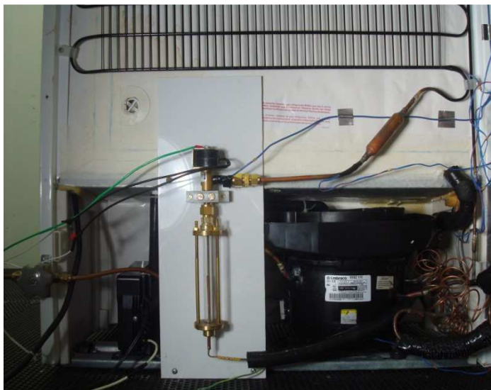
Figura 4.17 Posicionamento da válvula, câmara intermediária e tubo capilar saindo da última.
