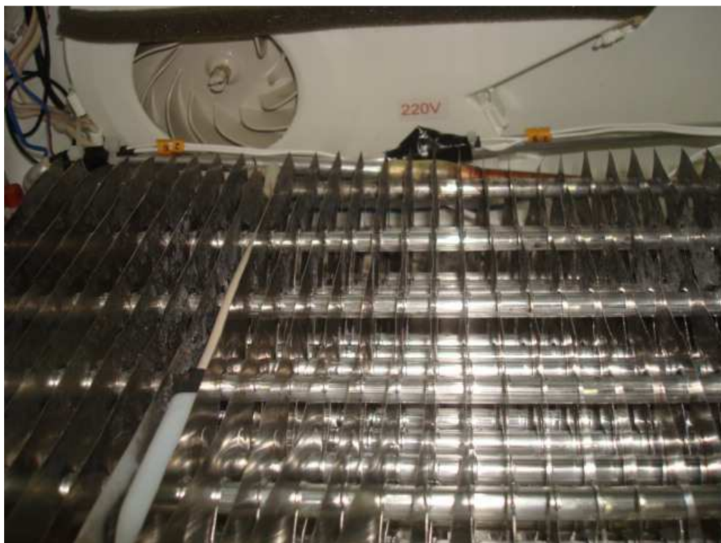
Figura 4.5 Termopares na entrada e saída do evaporador.
