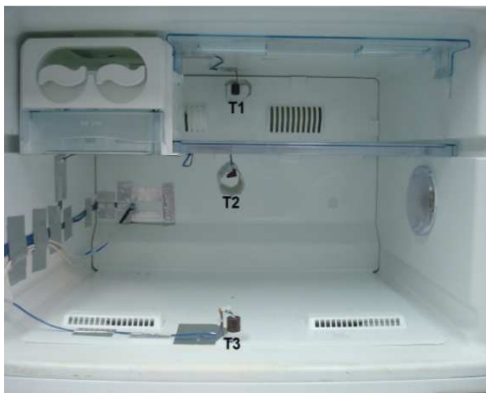
Figura 4.3 Termopares no congelador.
