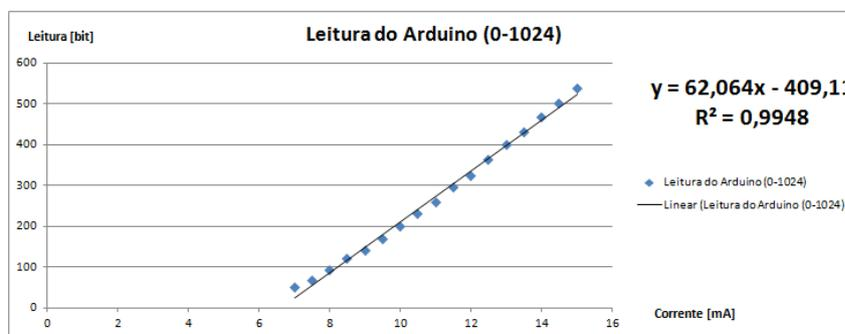
Figura 3.18: Faixa de operação aproximadamente linear do optoacoplador 4N35
