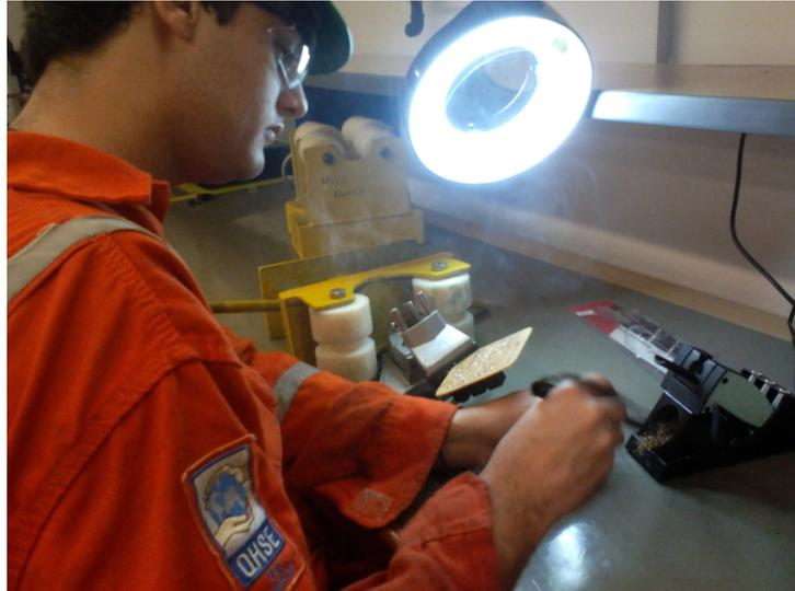
Figura 3.24: Soldagem de componentes eletrônicos
