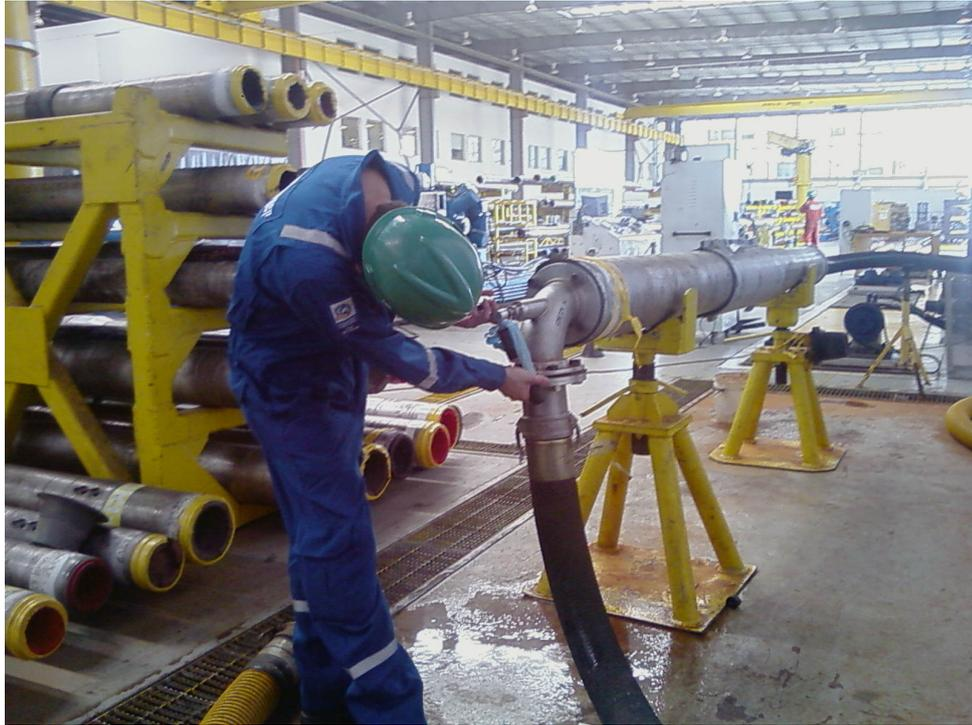
Figura 1.10: *Flow Loop Test* - Técnico medindo o torque de ferramenta *push-the-bit*
