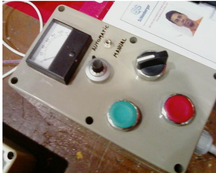
Figura 3.3: Módulo de controle do inversor - Posição *automático* e *manual*
