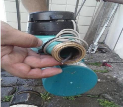
Figura 4 - Foto de Exemplo de fraude (Travamento do rotor com haste de metal).
