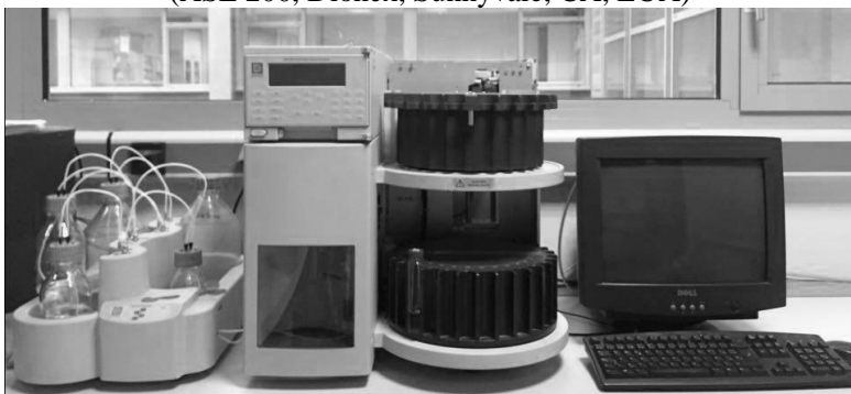
Figura 23 - Foto do equipamento de extração com líquidos pressurizados (ASE 200, Dionex, Sunnyvale, CA, EUA)
