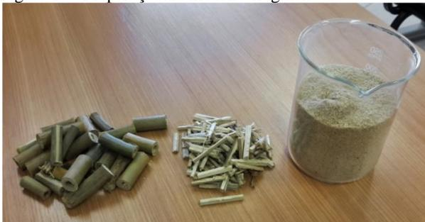
O material fragmentado foi lavado com água ultrapura. O processo de lavagem foi realizado em peneiras de ensaio granulométrico (Tabela 4), de modo a selecionar uma faixa granulométrica específica para os ensaios de adsorção. A retenção e secagem do material retido no fundo das peneiras foi realizada por filtração da água de lavagem em microfiltro de fibra de vidro (GF1 – Macherey-Nagel), e posterior raspagem e secagem do material.
