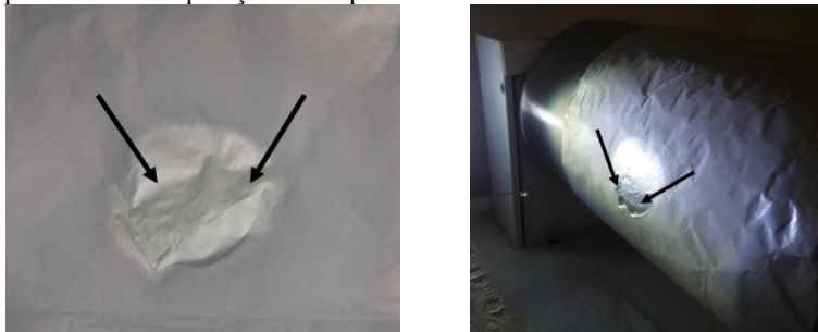
Figura 18: Evaporação incompleta do solvente. As setas apontam a região em que ocorria a evaporação incompleta do solvente.
