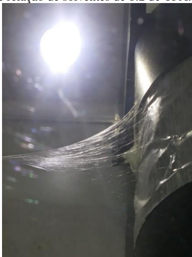
Figura 17: “Teias” formadas durante os ensaios de eletrofiação, nas condições de vazão de 4,8 mL/h, diferença de potencial de 26 kV e distância de 12 cm, solução de 30% de PET e relação de solventes de 8:2 de TFA:DCM.
