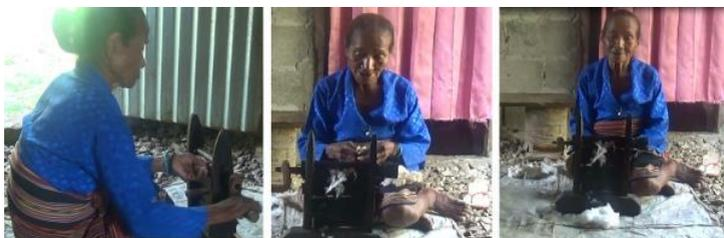
Figura 4 - **Processo do descaroçamento de algodão de fibra pequena.**
