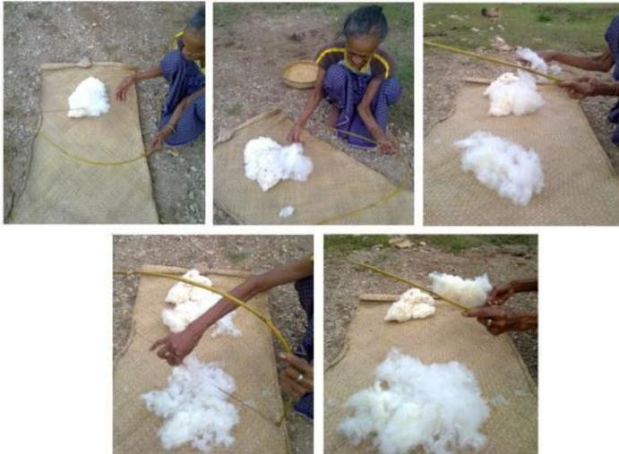
Figura 7– **Processo do refinamento de algodão de fibra pequena.**
