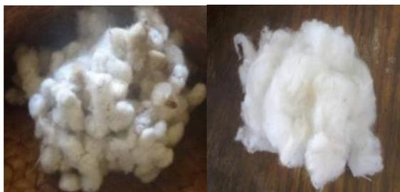
Figura 5 - **Comparação das texturas do algodão no início e final do descaroçamento.**
