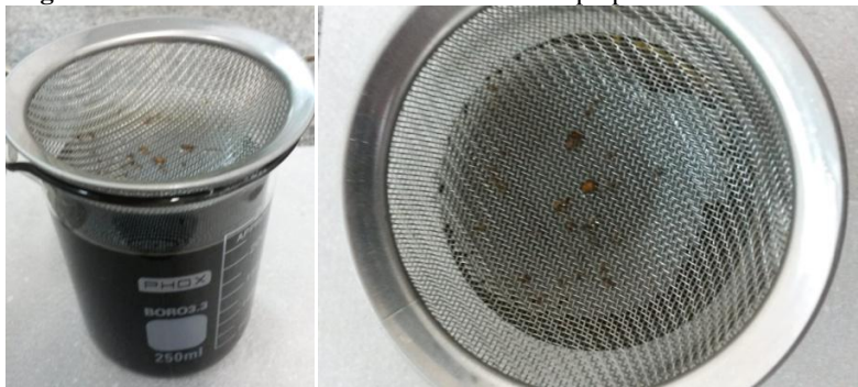
Figura 14 - Resíduos sólidos retirados do óleo de polpa de macaúba bruto.
