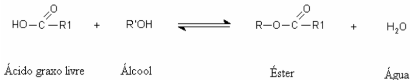
Figura 11 - Reação de esterificação do ácido graxo livre.
