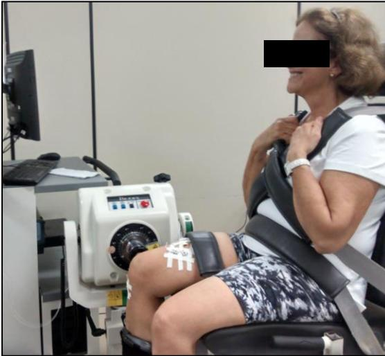
**Figura 3.** Posicionamento no dinamômetro isocinético para a avaliação dos músculos do joelho.
