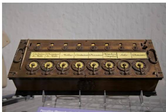
Figura 4 - Calculadora mecânica: fazia adição e subtração
