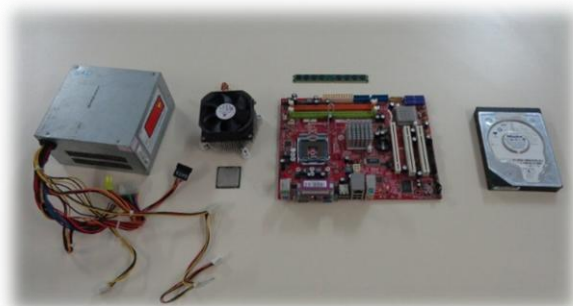
Figura 15 - Componentes que fazem parte de um computador pessoal de mesa
