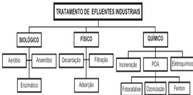
**Figura 1:** Fluxograma de alternativas para o tratamento de efluentes industriais
