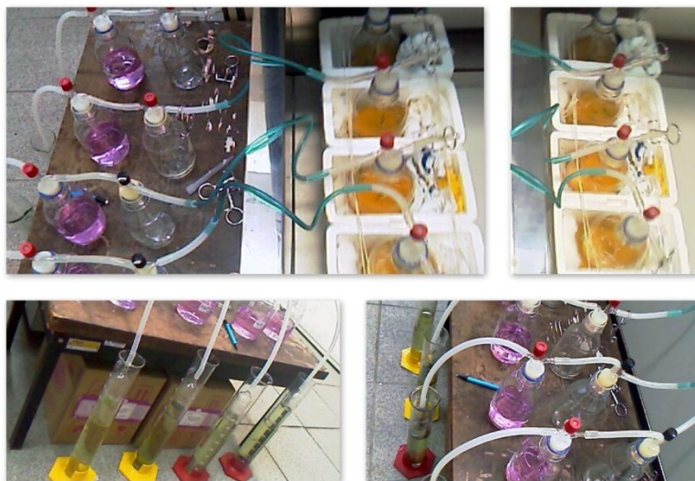
Figura 3-6 - Reactores anaeróbicos utilizados e aparato experimental acoplado
