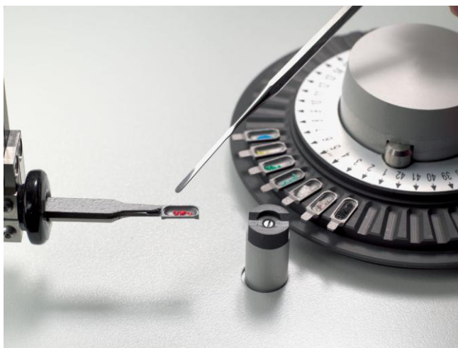
Figura 2. Foto do amostrador automático para espectrômetro de absorção atômica com forno de grafite (Analytik Jena).
