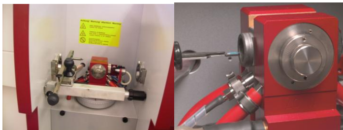
Figura 1. Fotos do forno de grafite em um espectrômetro de absorção atômica com o sistema manual de introdução de amostra sólida (Analytik Jena, Jena, Alemanha).
