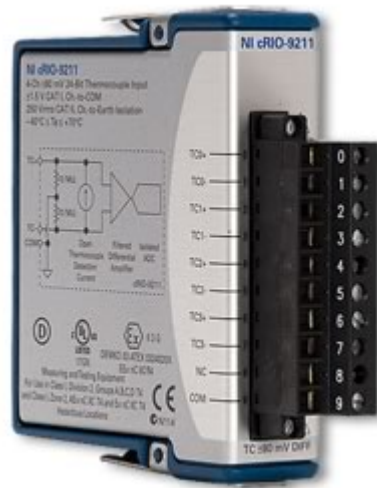
Figura 5.3: Módulo de aquisição NI9211 [12]
