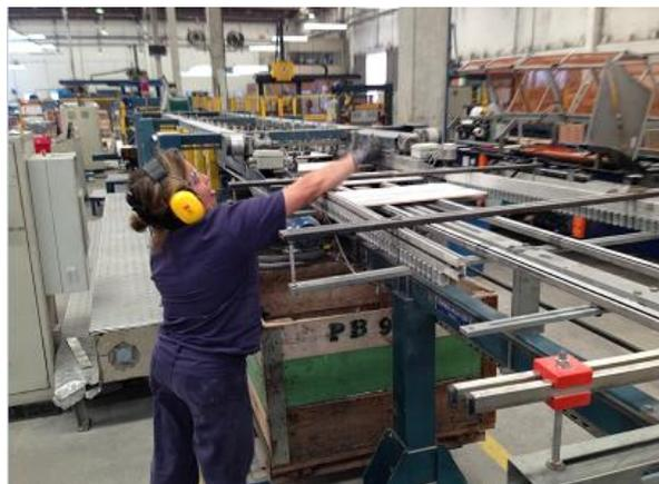
*Figura 4.24 - Marcação da peça em movimento após a mesa de classificação*
