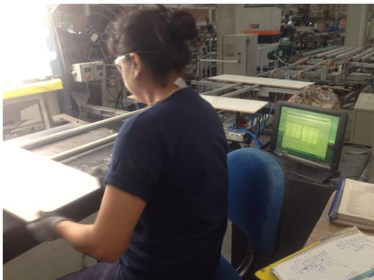
*Figura 4.19 - Replicação da tela de produtividade do palletizador em um computador auxiliar já existente*
