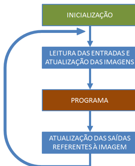
Figura 6 - Ciclo de varredura de um CLP.[25]
