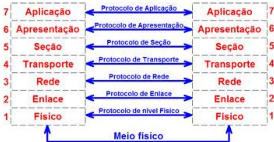
Figura 5 - Camadas do Protocolo ISO/OSI.
