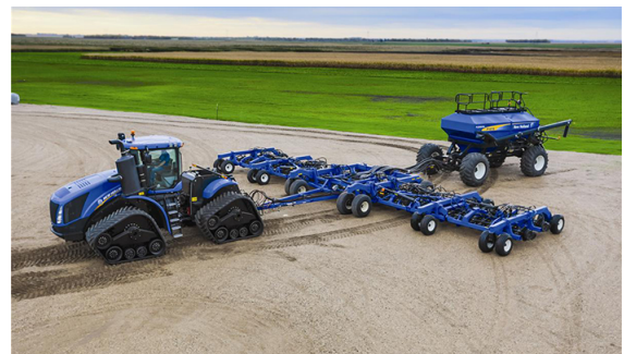
(d) Trator de esteira articulado com sistema de esteira para maior potência e também aderência do solo
