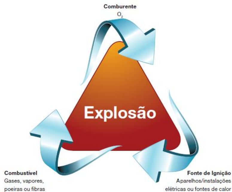
Figura 13 - Como ocorre uma explosão durante a operação de motores.
